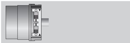
Spostare l'interruttore del relativo fine corsa dalla posizione di programmazione alla posizione di cancellazione.
