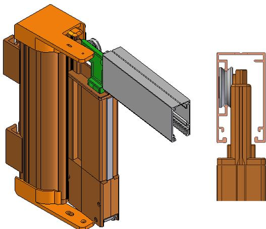
**6) FISSARE LA GUIDA SUPERIORE UTILIZZANDO L'APRISPAZZOLINO**
