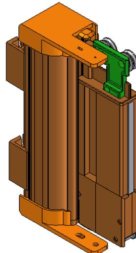
**5) INSERIRE LA GUIDA SUPERIORE FACENDO PASSARE LE RUOTE DEL CARRELLO NELL'APPOSITA SEDE**
